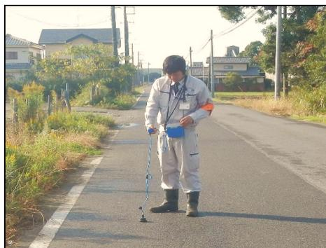
漏水調査（音聴検査）
