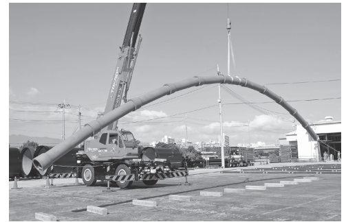
耐震性に優れた水道管（ダクタイル鋳鉄管） 「一般社団法人日本ダクタイル鉄管協会」提供
